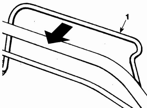
Pour les modèles autopropulsés, l'avancement de la tondeuse est obtenu lorsque le levier (1) est poussé contre le guidon; la machine cesse d'avancer lorsque le levier est relâché.
