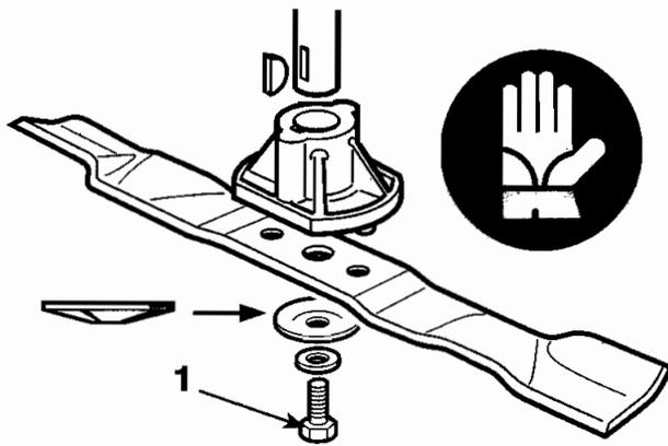
S'il est nécessaire d'intervenir sur la lame, la remonter en respectant l'ordre illustré sur la figure; veiller à serrer la vis centrale correctement (1) à un couple de 35-40 Nm (3,5-4 kgm).
