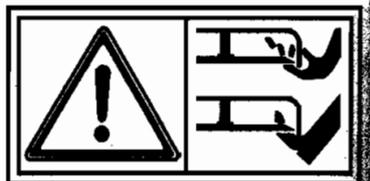
**Risque de coupure.** Lame tournante. Ne pas introduire les mains et les pieds dans le carter de coupe.
