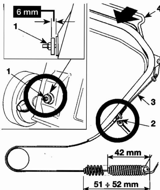
On obtient la bonne tension de la courroie à l'aide de l'écrou (1), soit en atteignant la mesure indiquée (6 mm).
