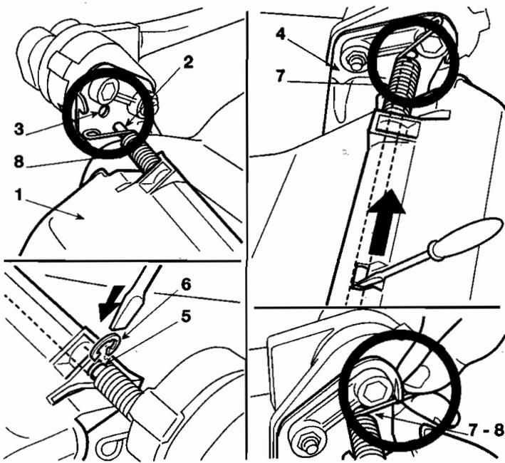
Pour monter le pare-pierres (1), faire sortir l'extrémité gauche de l'axe (2) et l'introduire dans le trou du support gauche (3) du carter de coupe. Aligner l'autre extrémité de l'axe dans le trou correspondant du support droit (4) et, à l'aide d'un tourne-vis, pousser l'axe dans le trou jusqu'à rendre accessible la rainure (5). Introduire dans la rainure l'anneau élastique (6) et accrocher les ressorts droit (7) et gauche (8), comme il est indiqué sur la figure.
