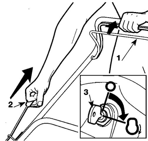
Pour le démarrage, lire attentivement les instructions données dans le manuel d'utilisateur du moteur, puis tirer le levier de frein de lame (1) contre le guidon et tirer sur la poignée du lanceur (2). Pour les modèles équipés d'un démarreur électrique, tourner la clé de contact (3).
