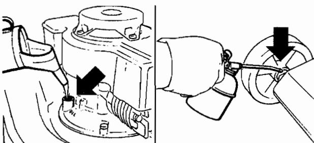
Vérifier le niveau d'huile avant l'utilisation et compléter si nécessaire, selon les indications du livret du moteur. Huiler les axes et les articulations des roues.
