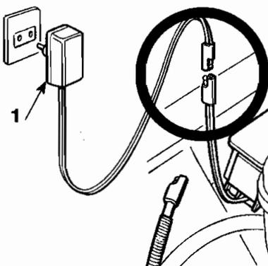
Pour recharger une batterie déchargée, la brancher sur le chargeur (1) selon les instructions du manuel d'entretien de la batterie. Si vous prévoyez de ne pas utiliser la tondeuse pendant une longue période, débranchez-la du câblage électrique de la machine en maintenant cependant un bon niveau de charge.
