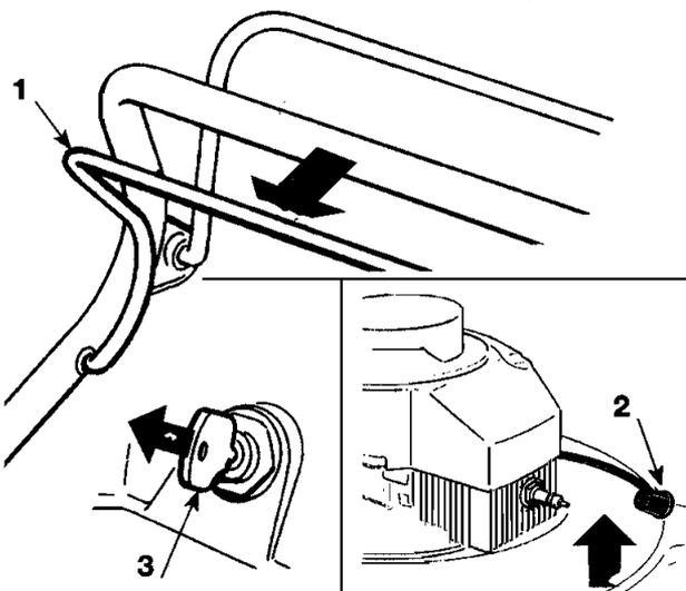
Lorsque le travail est terminé, relâcher le levier (1) du frein de lame et débrancher le capuchon de la bougie (2). Enlever la clé de contact (3) pour les modèles qui en sont équipés. ATTENDRE QUE LA LAME SOIT ARRÊTÉE avant d'effectuer toute intervention sur la tondeuse.
