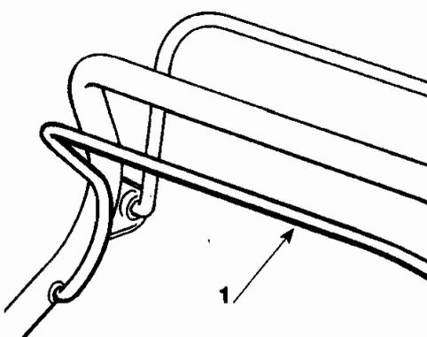
Le frein de lame est actionné par le levier (1) qui devra toujours être maintenu contre le guidon par l'opérateur pour le démarrage et pendant le fonctionnement de la tondeuse. Le moteur s'arrête dès que le levier est relâché.
