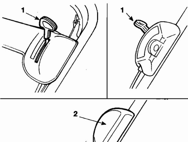
L'accélérateur (si présent) est commandé par le levier (1). Les positions du levier de gaz sont indiquées sur l'étiquette correspondante. Certains modèles prévoient un moteur à régime fixe où l'accélérateur n'est pas nécessaire (2).
