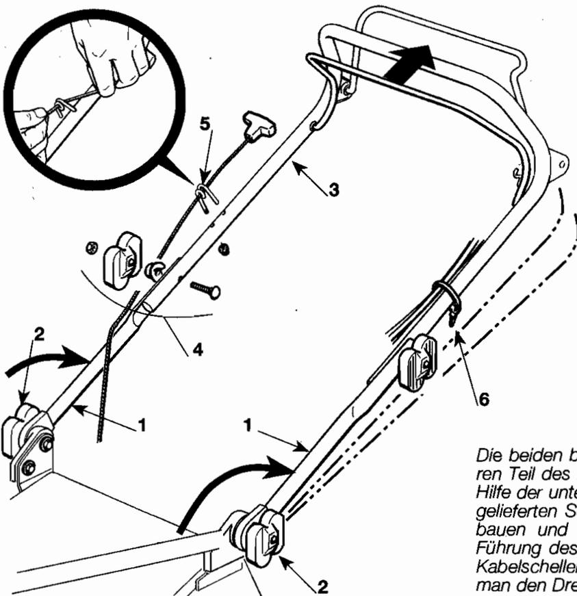
Remettre en position de marche les deux éléments (1), déjà préinstallés, qui composent la partie inférieure du guidon et les bloquer à l'aide des poignées inférieures (2). Monter la partie supérieure (3) en utilisant la visserie (4) fournie à cet effet et veiller à positionner correctement le crochet (5) de guidage de fil du lanceur. Fixer les câbles de commande en utilisant les colliers (6). Il est possible, en desserrant les poignées (2), de régler le guidon sur trois hauteurs différentes.
